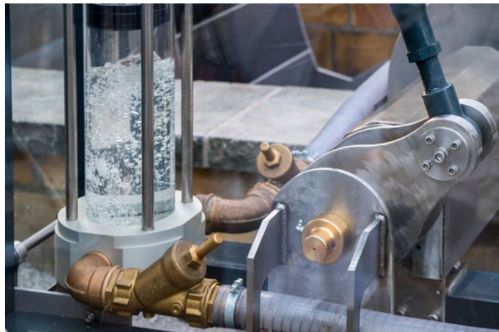
Zur Veranschaulichung des Förderprinzips von Paderwasser in die höher gelegenen Laufbrunnen der Innenstadt wurde ein großes Funktionsmodell einer durch Wasserkraft angetriebenen Pumpe an der Börnepader errichtet und am 23.8.2017 eingeweiht.
